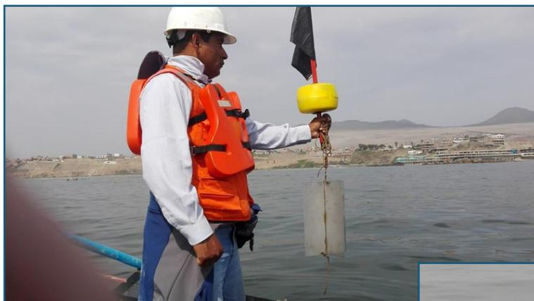
Vista del flotador listo para su empleo y luego de ser puesto a la deriva en la Bahía de Chancay para determinar la corriente superficial.
